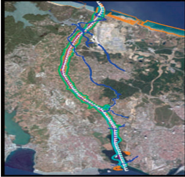
Şekil 48. Kanal Güzergâhı Kesişen İsale Hatları
